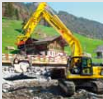
Der 30-t-Komatsu PC 290 mit Partikelfilter.
